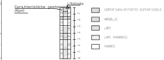
GIUDIZIO SINTETICO DELLE CARATTERISTICHE GEOTECHNICHE DEI TERRENI BASATO SULLA RESISTENZA ALL'INFISSIONE DELLA PUNTA PENETROMETRICA
